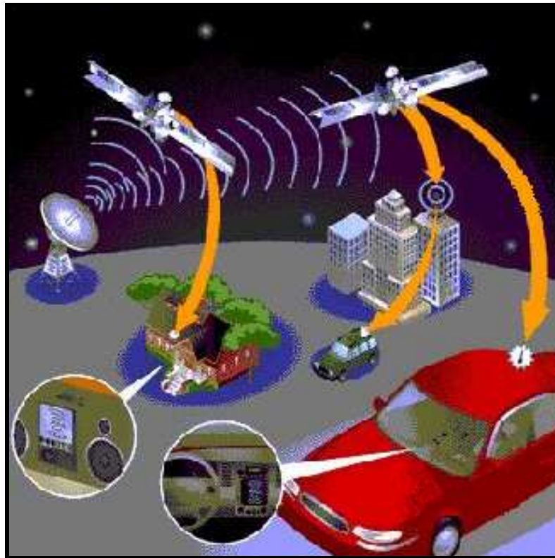
Gráfico 1 - Esquema del funcionamiento de la radio satelital
