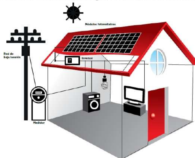
Ilustración 3-1. Instalación de energía solar fotovoltaica en una vivienda.
