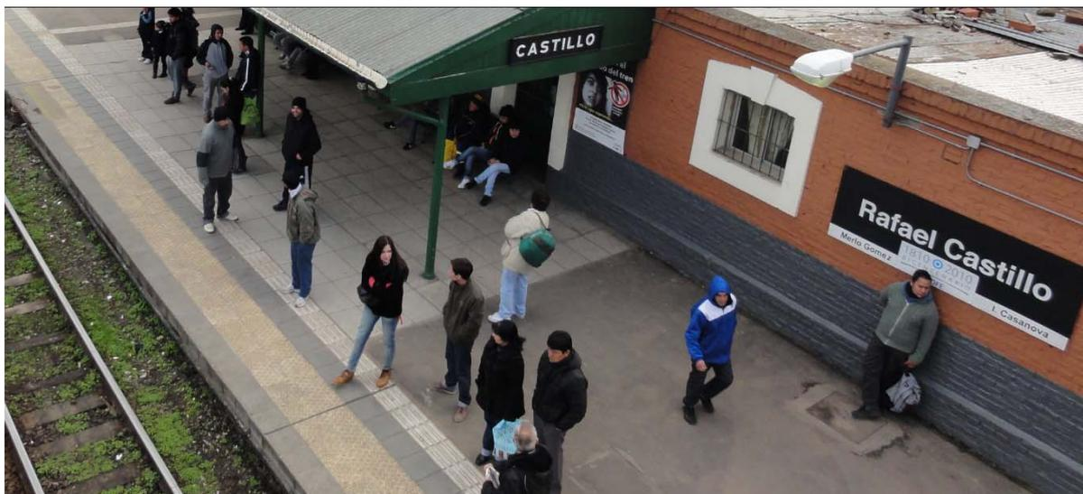
Fig. 11: Andén descendente tipo, aún sin elevar, construido en los últimos 7 años con losas impermeables, borde amarillo y sendero para no videntes. Se trata de una mejora respecto a la situación previa, en la que persistían andenes de tosca y carbonilla, pero sigue un formato arquitectónico inadecuado para la demanda potencial. La reforma de las estaciones es probablemente el componente físico que mayor esfuerzo de rediseño y construcción requiera.
