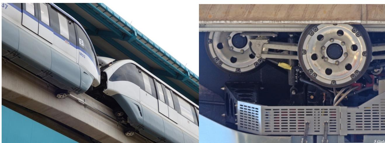
Fig. 2: Vehículo con desplazamiento sujeto a carril. Fotos de Sergio Mazzi y F/ Giolo, (2014), tomadas de Skyscrapercity, Monotrilho Expresso Tiradentes.
