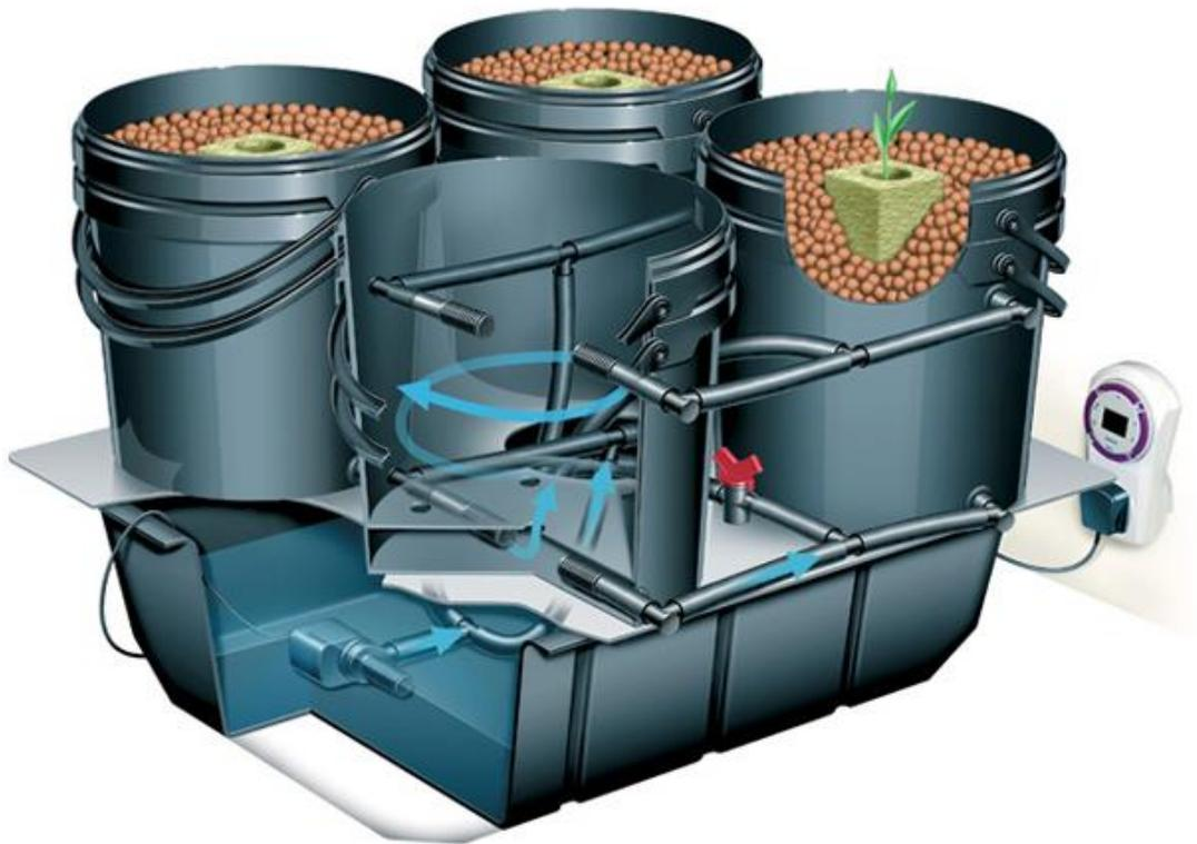
Figure 12. Sistema hidropónico de flujo y drenaje
