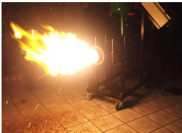
Ilustración 16. Quemador experimental con combustión en base a cáscara de pecan
