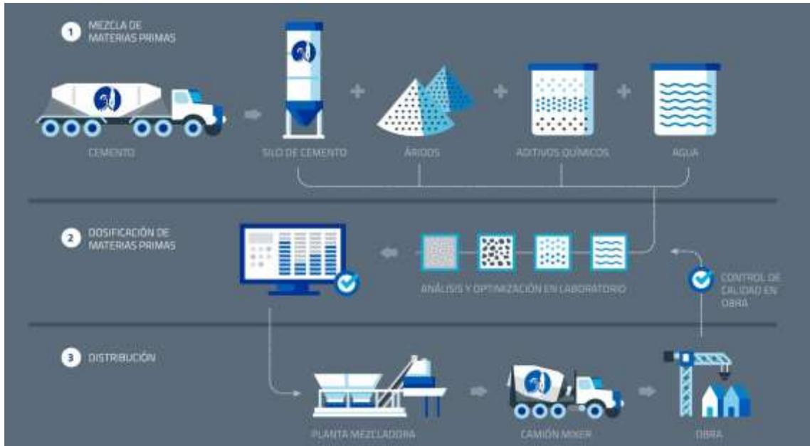
1. Mezcla de materias primas: En primer lugar, se diseña la mezcla, determinando las propiedades requeridas del hormigón de acuerdo con el uso que se le quiere dar. Luego, se realiza la extracción, clasificación y transporte de agregados (piedra partida o canto rodados de distintos tamaños); arena, cemento, aditivos y agua. Éstos se encontrarán almacenados en depósitos al aire libre, la arena y piedra contarán con un depósito individual.
